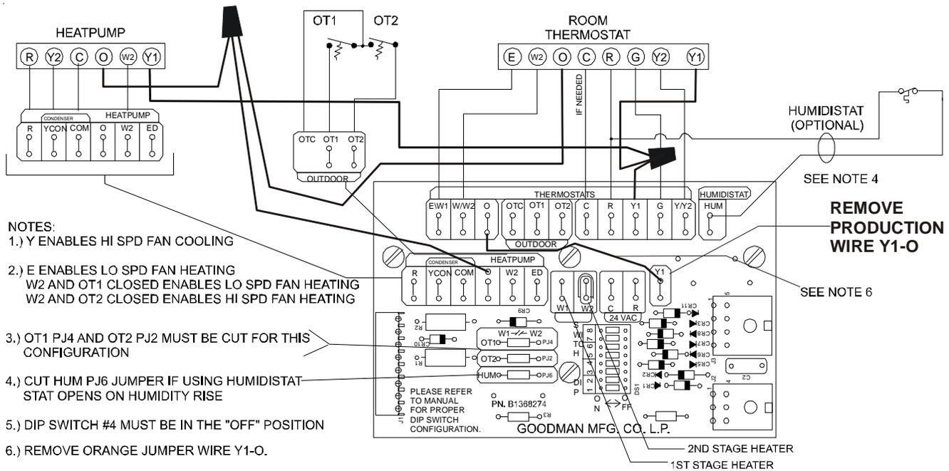
NO AUX HEAT IN HEATPUMP MODE UNTIL OUTDOOR T'STAT CLOSES
