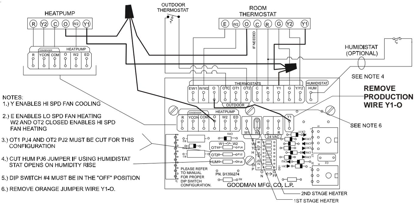
NO AUX HEAT IN HEATPUMP MODE UNTIL T'STAT CLOSES
