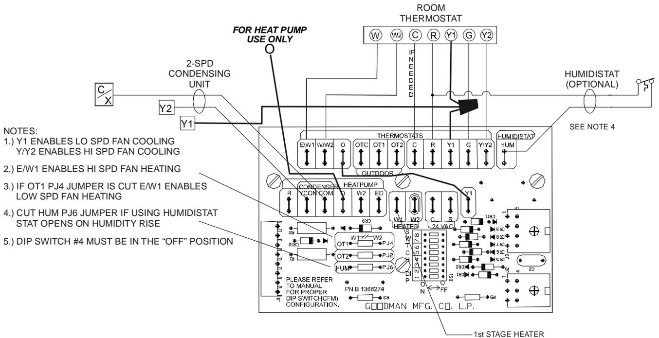
**2 SPD COOLING ONLY - WITH 2 STAGE HEAT THERMOSTAT**
