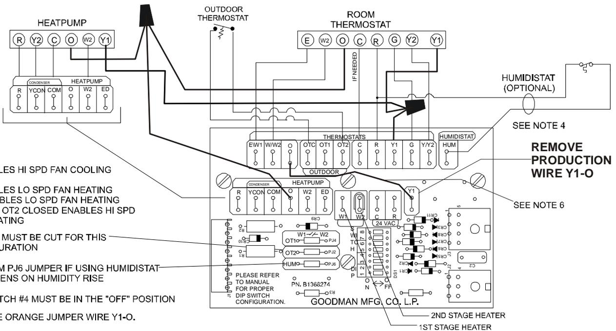
1ST STAGE AUX HEAT ENABLED BY ROOM T'STAT
