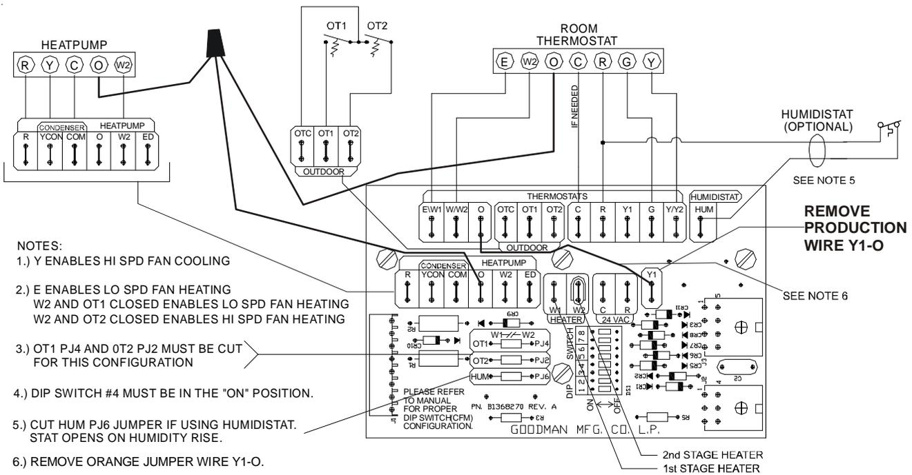
NO AUX HEAT IN HEATPUMP MODE UNTIL OUTDOOR T'STAT CLOSES
