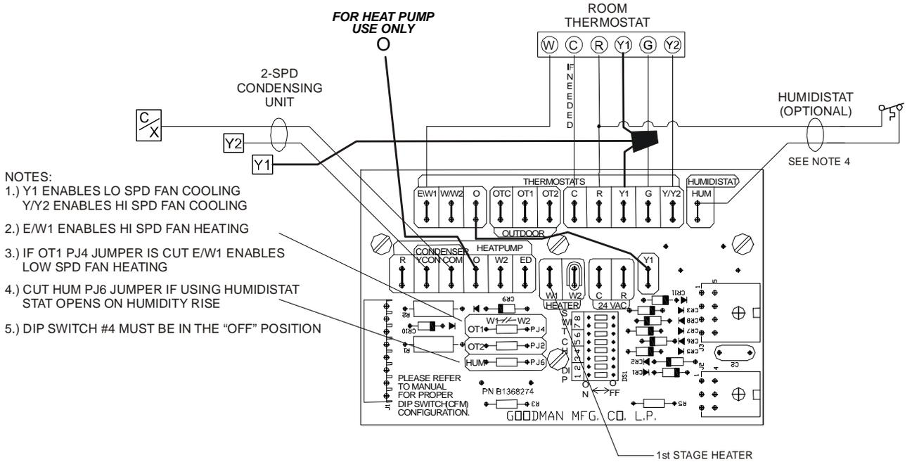
**2 SPD COOLING ONLY - WITH 1 STAGE ELECTRIC HEAT**
