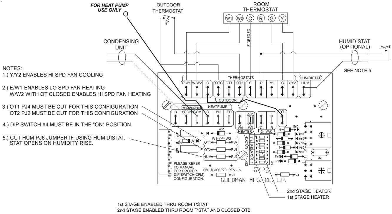
**COOLING ONLY - 2 STAGE HEAT (T'STAT ENABLED OT)**
