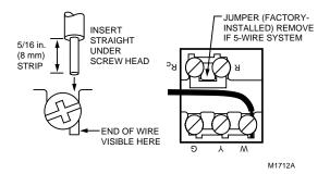
Fig. 3. Proper wiring technique.
