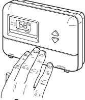
B PRESS LOWER EDGE OF M113 CASE TO LATCH.
